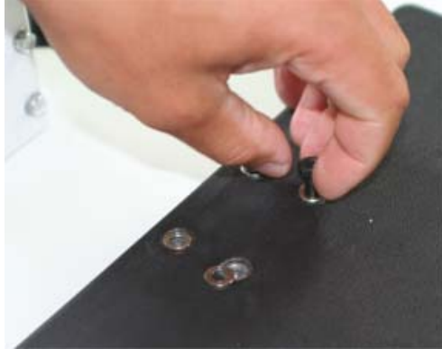
Figura 3-1. Retire los Tornillos Hexagonales de la Plataforma de la Báscula
